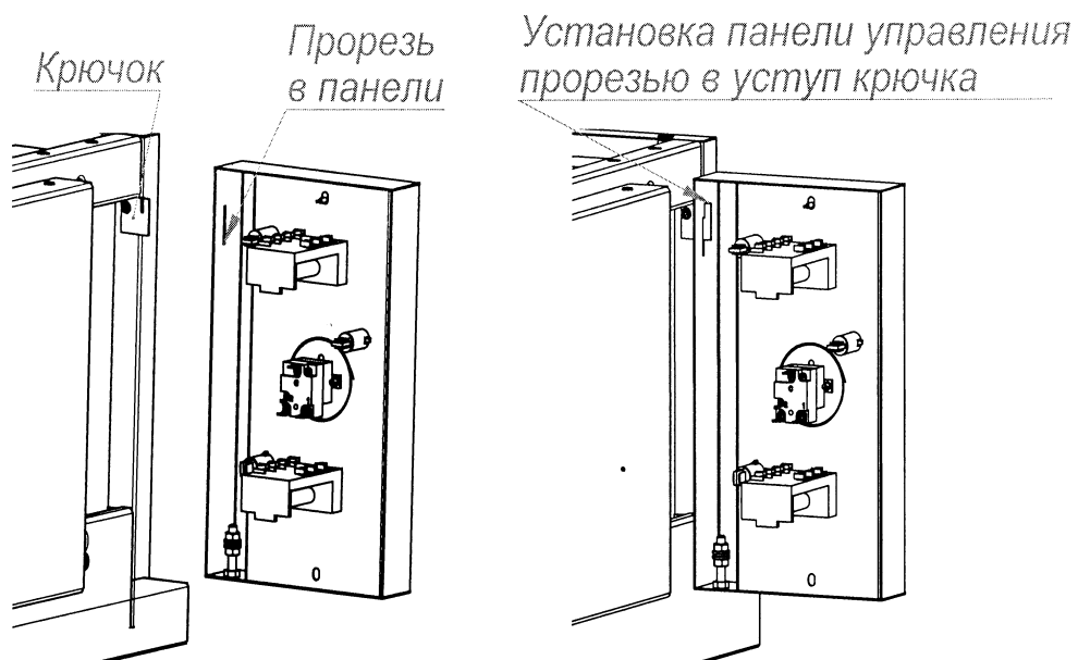
Рис. 4 Схема установки панели управления при ТО
