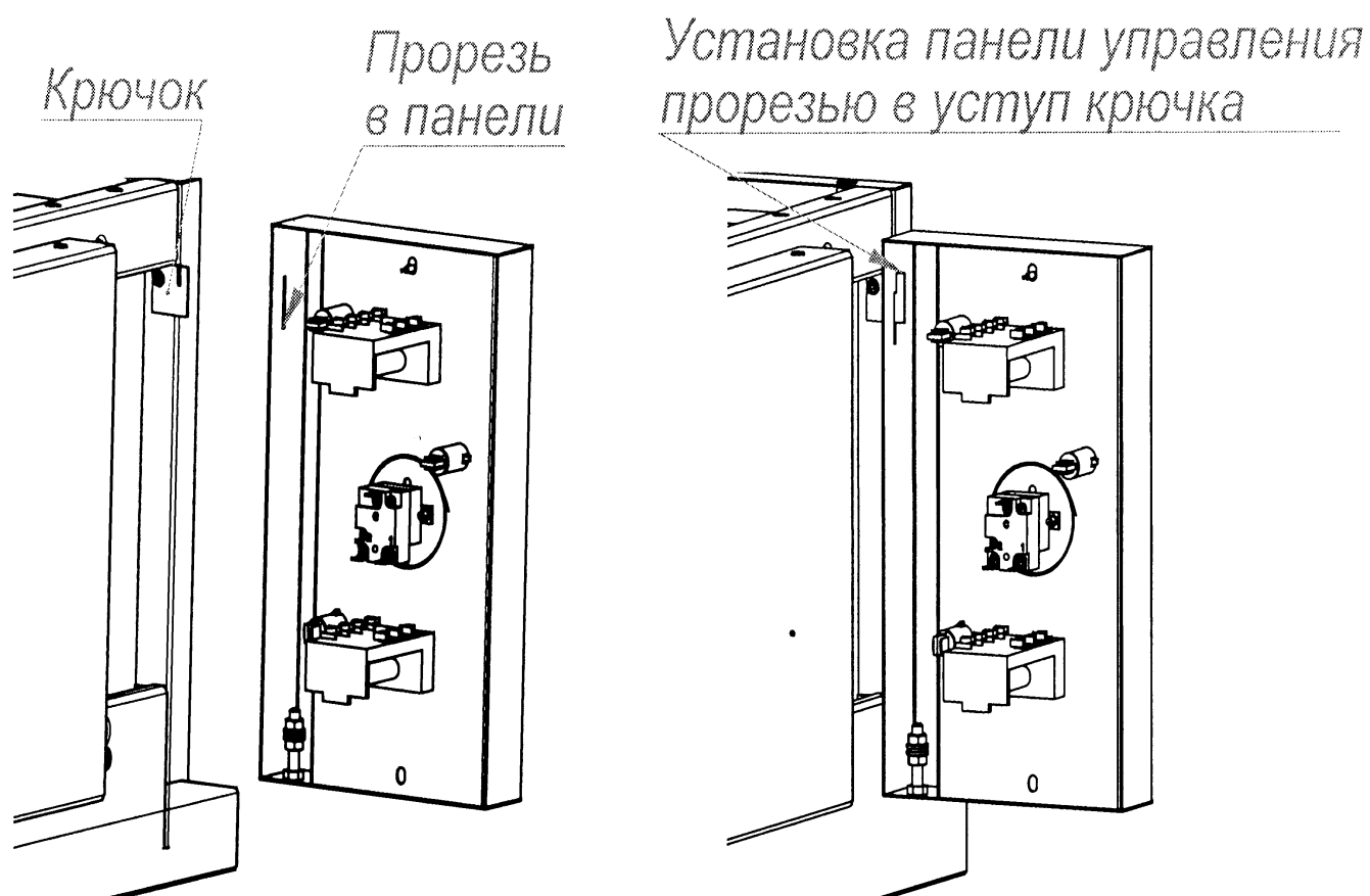
Рис.5 Схема установки панели управления при ТО
